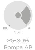
Nei ponti e tunnel di lavaggio, applicare il prodotto con una pompa dosatrice. Con le acque dure (400 ppm) si suggerisce un dosaggio di circa 25 ml/min, cercando di mantenere la percentuale della pompa tra 25-30%. Per le acque osmotizzate si può ridurre leggermente la portata del prodotto chimico attorno a 22 ml/min.
